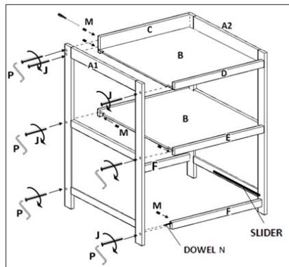
**Schritt 1 :** Benutzen Sie das Seitenrahm **A2**, die Regale **B**, den Rücken **C**, die Querlatten **D-E-F**, sieben Bolzen **J**, sieben zylindrische Mutter **M** und den Sechskantschlüssel **P**
