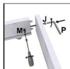
**Stap 3 :** Gebruik de onderdelen **X1-X2-X3** en **X4** voor de lade, de verbindingsbouten **G**, de excentrieken **L**, vier bouten **J**, vier cylindrische moeren **M** en twaalf houten deugels **N**
