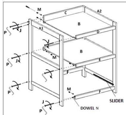
**Stap 1 :** Gebruik het rechtse pootonderstel **A2**, de leggers **B**, de ruglat **C**, de dwarslatten **D-E-F**, zeven bouten **J**, zeven cylindrische moeren **M**, vier houten deugels **N** en de zeskantsleutel **P**
