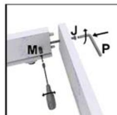
**Etape 3 :** Utilisez les pièces **X1-X2-X3** et **X4** du tiroir, les boulons de raccord **G**, les excentriques **L**, quatre boulons **J**, quatre écrous cylindriques **M** et douze chevilles en bois **N**.
