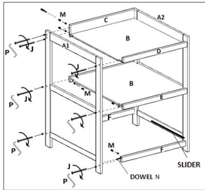
**Etape 1 :** Utilisez le piétement droite **A2**, les étagères **B**, la barrière dorsale **C**, les traverses **D-E-F**, sept boulons **J**, sept écrous cylindriques **M** et la clef hexagonale **P**
