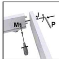
**Schritt 3 :** Benutzen Sie die Unterteile **X1-X2-X3** und **X4** der Schublade, die Verbindungsbolzen **G**, die Verbindergehäuse **L**, vier Bolzen **J**, vier zylindrische Mutter **M** und zwölf Holzdübel **N**.
